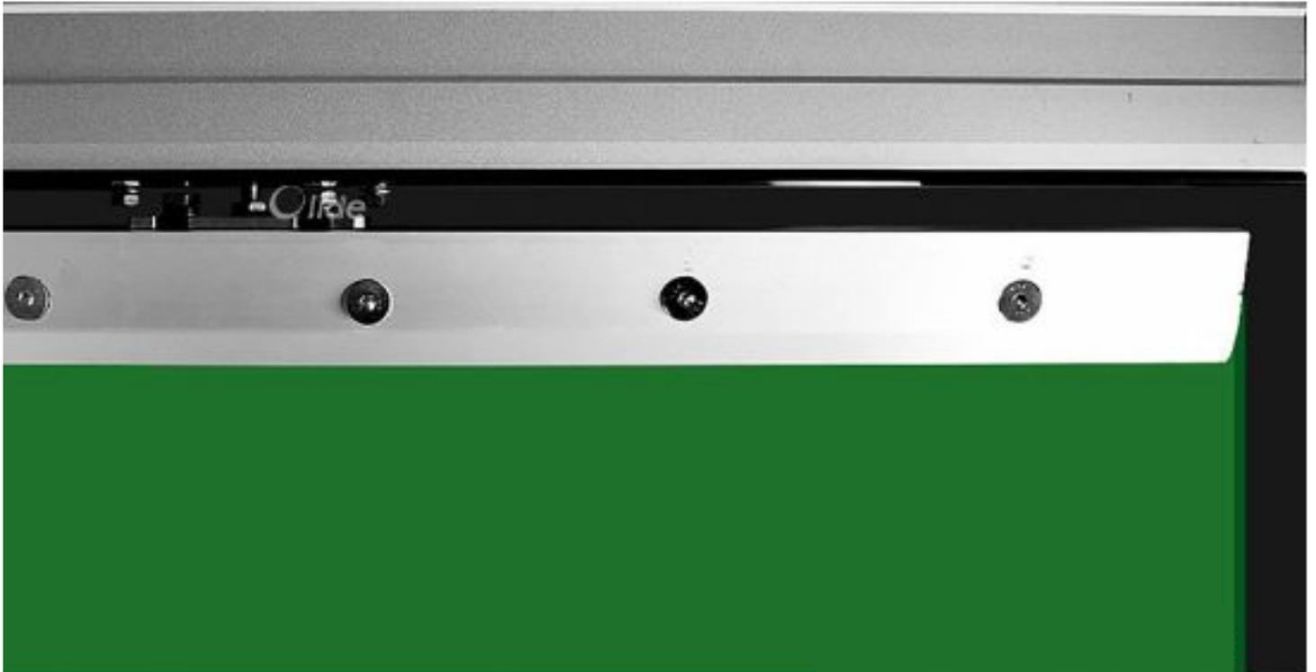
Para empezar, coloque la base fija en la suspensión larga. Se requerirán de dos bases para la fijación de un lado
